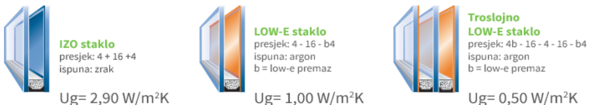
Slika 37: Značaj niskoemisionog premaza (Low-e) na staklima
