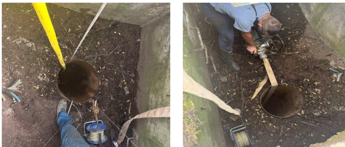
Slika br. 36 Izvođenje testova crpljenja na predmetnom bunaru i praćenje NPV na susjednim bunarima
