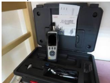
Slika 15. Aparatura za brojanje suspendovanih čestica u vazduhu, detekciju \text{CH}_2\text{O} i CO
