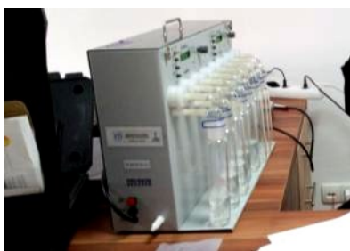
Slika 11. Aparat PROEKOS AT801X2 za poluautomatsko uzorkovanje vazduha
