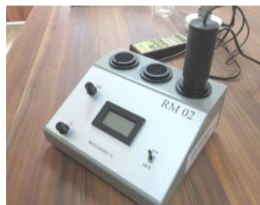
Slika 12. Reflektometar RM-02 za očitavanje zatamnjivosti filter-papira
