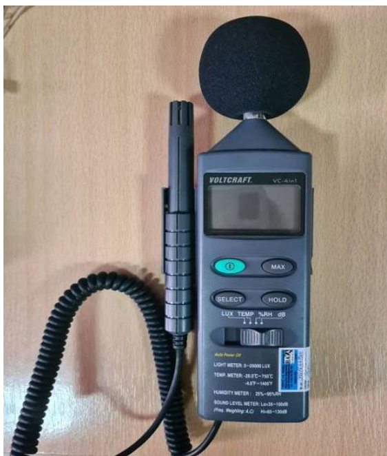
Slika 36. Bukomjer (integrirani mjerac zvuka) Voltcraft DT - 8820
