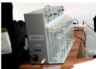
Slika 14. Aparat PROEKOS AT801X2 za poluautomatsko uzorkovanje vazduha
