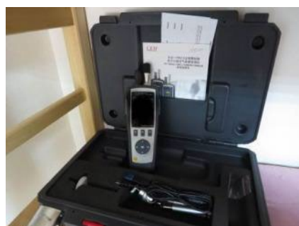
Slika 18. Aparatura za brojanje suspendovanih čestica u vazduhu, detekciju CH 2 O i CO
