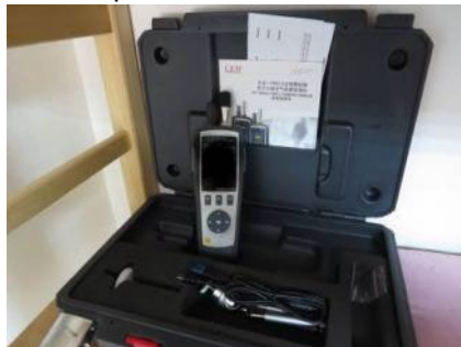
Slika 19. Aparatura za brojanje suspendovanih čestica u vazduhu, detekciju \text{CH}_2\text{O} i CO
