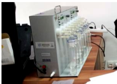
Slika 15. Aparat PROEKOS AT801X2 za poluautomatsko uzorkovanje vazduha
