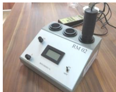
Slika 16. Reflektometar RM-02 za očitavanje zatamnjenosti filter-papira
