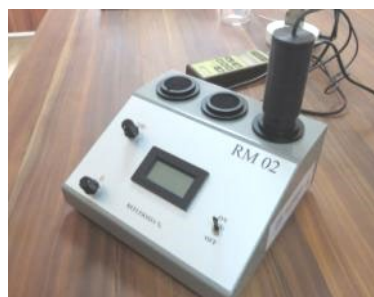
Slika 16. Reflektometar RM-02 za očitavanje zatamnjenosti filter-papira
