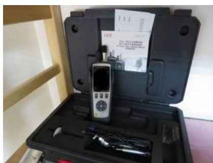
Slika 19. Aparatura za brojanje suspendovanih čestica u vazduhu, detekciju \text{CH}_2\text{O} i \text{CO}
