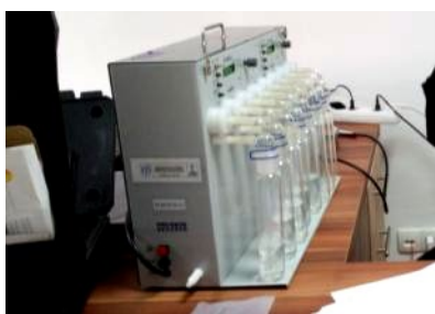
Slika 14. Aparat PROEKOS AT801X2 za poluautomatsko uzorkovanje vazduha
