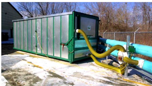
Слика 28. Примјер затвореног система компостирања
