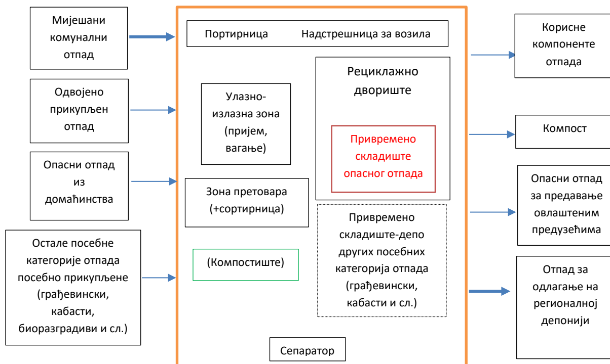
График 6. Шема централизованог погона за управљање отпадом
